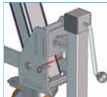
Fig.2 Stabilisateurs sécurisés avec goupilles et clips.
